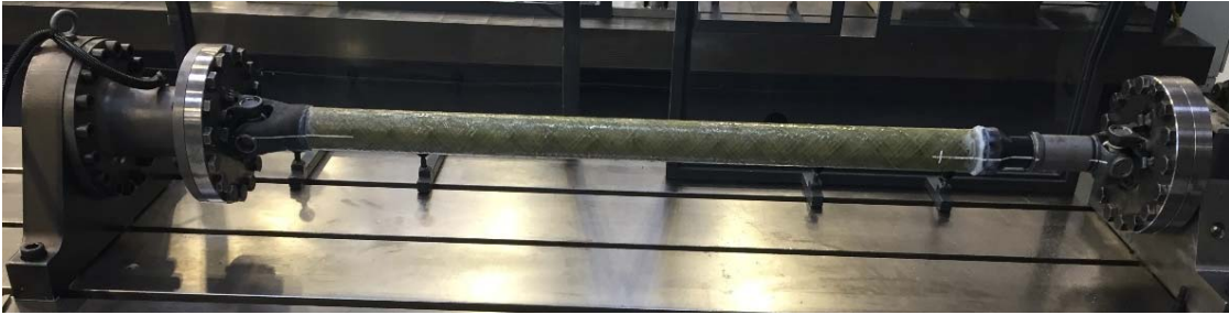
Şekil 13. Kompozit Kardan Mili Montajlı Komple Performans Testi
