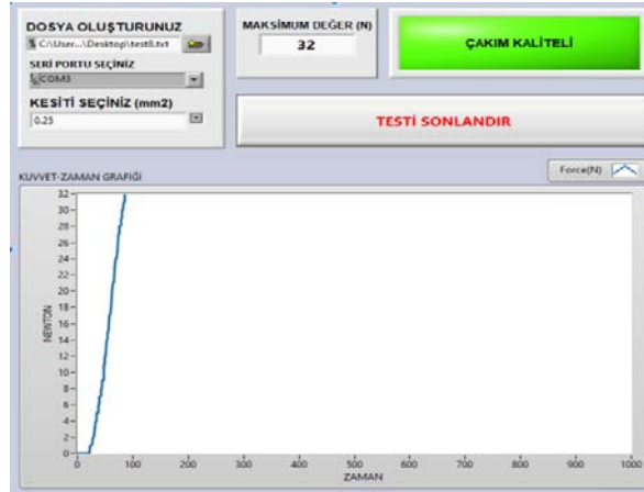
Şekil 7. Çekme test cihazı kaliteli çakım test sonucu
