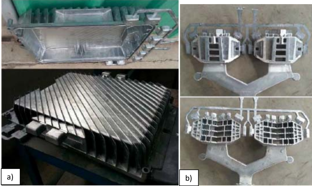
Şekil 27. RSF Metoduyla üretilmiş telekomünikasyon parçaları a)Telokom. Kutusu b)Telekom. Braketleri
