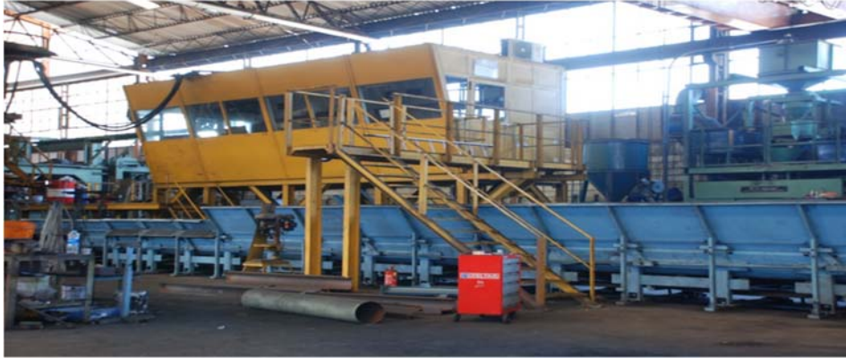
Şekil 4. DISA 2070-C otomatik dikey kalıplama hattı.
