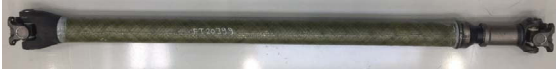
Şekil 10. Montajlı Komple Kompozit Kardan Mili
