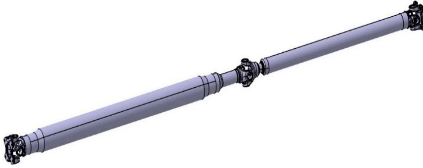
Şekil 4a İki parçalı kardan mili katı modeli
