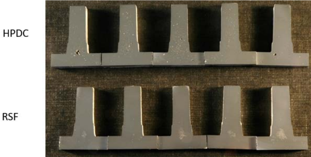
Şekil 28. RSF Yöntemi ve HPDC Yöntemi porozite karşılaştırması
