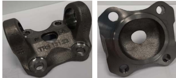
Şekil 5. Talaşlı imalat prosesleri yapılan döküm çatalı flanş
