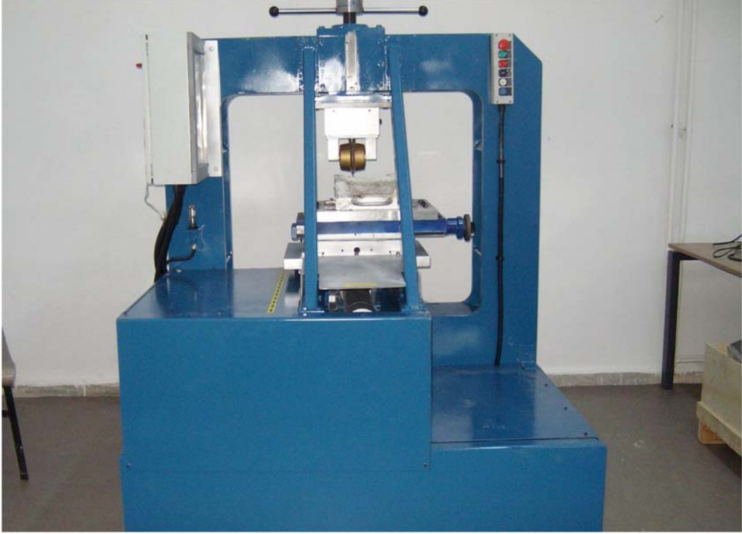
Şekil 3. Taşınabilir doğrusal kaya kesme setinin genel görünümü (Çomaklı, 2015)
