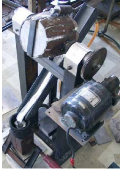
Şekil 8. Eğimli Soğutma Plakasında Döküm Ünitesi Örneği [22]
