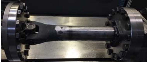
Şekil 12. Kompozit Tüp Çatal Performans Testi
