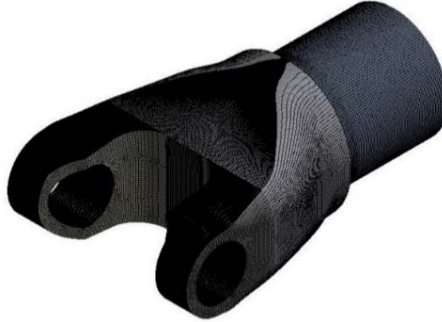
Şekil 4. Sonlu Elemanlara Ayrılmış Kompozit Tüp Çatal
