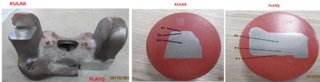
Şekil 4. Parçaların iç yapı incelemeleri için alınan kesitler
