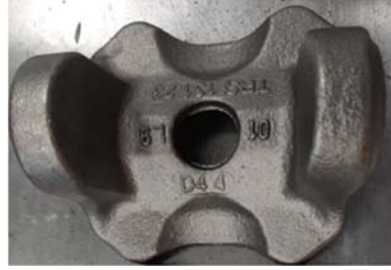
Şekil 3. Döküm prototipi yapılan çatalı flanş
