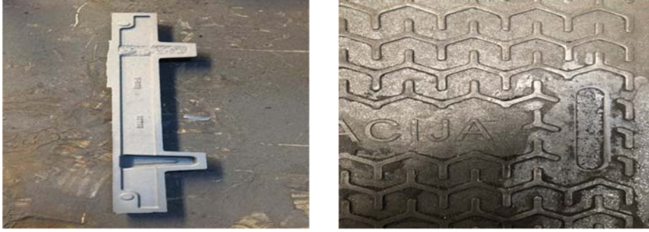
Şekil 3. Kum kalıp koparma hatası.
