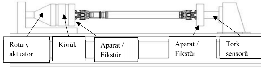
Şekil 2. Statik Torsiyon Test Cihazı
