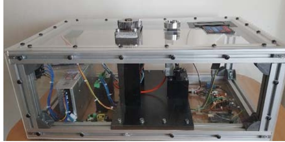
Şekil 6. Geliştirilen çekme test cihazı
