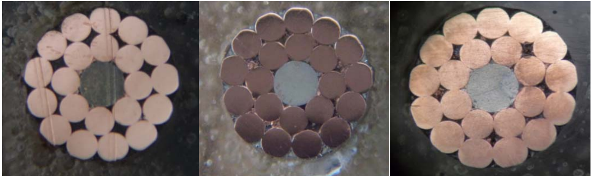
Şekil 2. 6 mm 2 hibrit iletken ürün yapısı (Deneme -1, Deneme- 2, Deneme-3)
