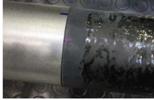
Şekil 11. Birleştirme Bölgesi Testi ve Kontakta Meydana Gelen Kayma
