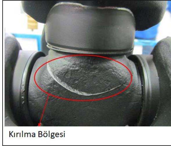
Şekil 3. Birinci seviye prototip istavroz gövdesinde oluşan kırılma
