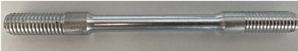
Şekil 2 : AA 6082-T6 Dolu Parça Çekme Numunesi
