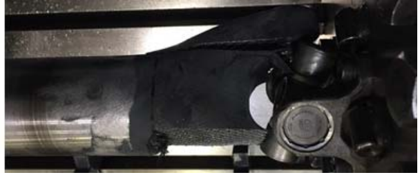
Şekil 12. Kompozit Tüp Çatal Performans Testi
