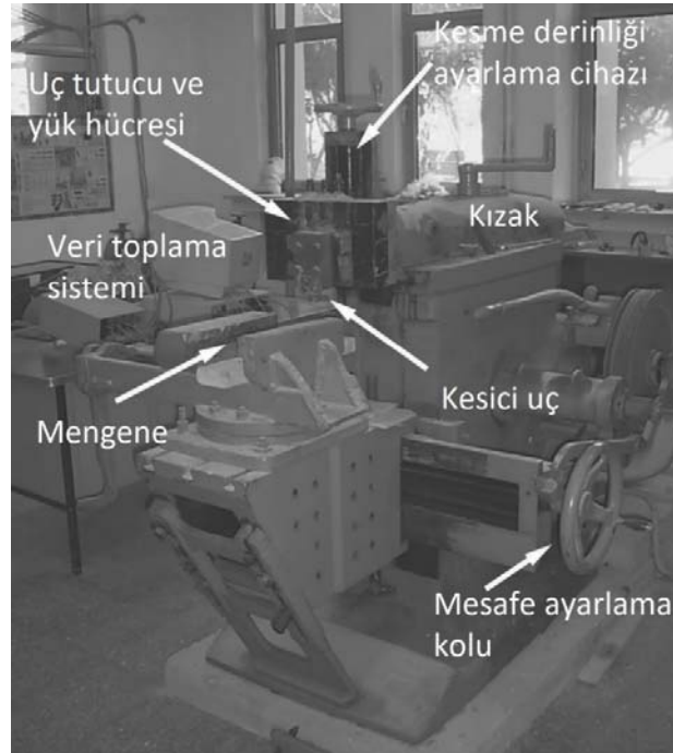
Şekil 1. Küçük boyutlu doğrusal kesme seti (Bilgin vd., 2010)
