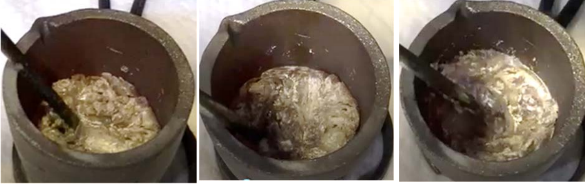
Şekil 2. %30 katı - %70 sıvı Al-Si alaşımasının tiksotropik davranışı [3]
