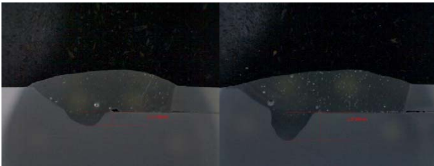
Şekil 6. 3. Grup kaynak parametreleri için nüfuziyet derinlikleri
