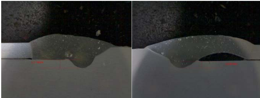
Şekil 4. 1. Grup kaynak parametreleri için nüfuziyet derinlikleri
