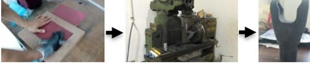
Şekil 9. Kompozit Tüp Çatal Prototip Üretimi
