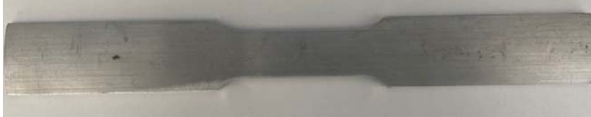
Şekil 1 : AA 6061-T6 Boru Çekme Numunesi
