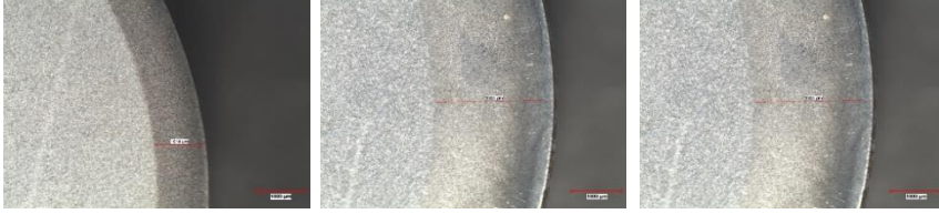
Şekil 7. Optik mikroskopta Clemex programı ile sertlik derinliklerinin kontrolleri, sırasıyla 1,1 mm, 2,2 mm ve 2,7 mm
