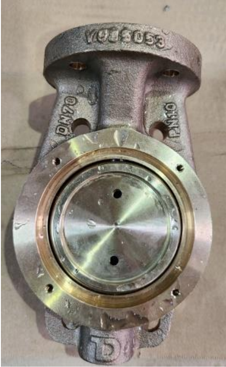
Şekil 6. Güçlendirilmiş yeni tasarımın şok testi sonrası görüntüsü.
