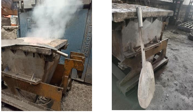
Şekil 4. Tretman/taşım potası ve pota kapağı
