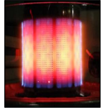
Şekil 7: Brülörde Alev Geri Tepmesi
