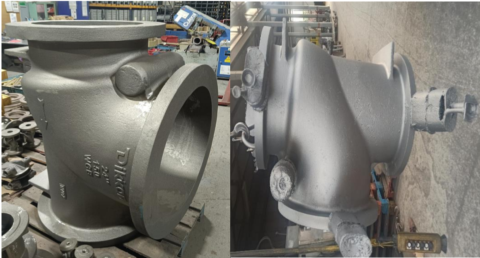
Şekil 6. Çalpara çekvalf gövde işleme öncesi görsel.
