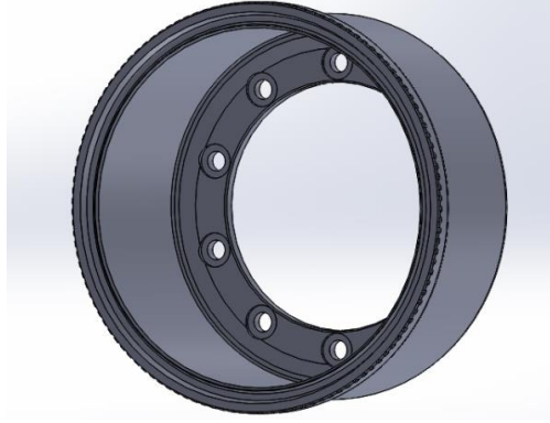
Şekil 1. Çalışmada kullanılan kampananın 3D tasarımı
