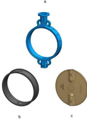
Şekil 3. Wafer Tip Kelebek Vana Tasarımların Ayrıştırılmış Hali a) GGG40.3 Sfero Gövde b) EPDM Kauçuk Kaplama c) CuSn10 Klape.
