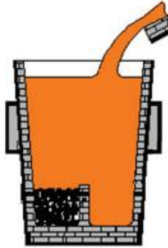
Şekil 2. Cepli açık pota Mg tretmanının şematik gösterimi [Kiss I. 2021]
