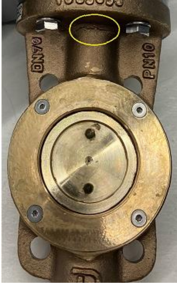
Şekil 5. Şok testi sonrası oluşan çatlak.
