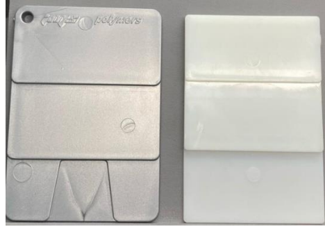
Şekil 4: Metalik görünümlü ve doğal görünümlü ABS kompozit malzemelerin görsel olarak karşılaştırılması.
