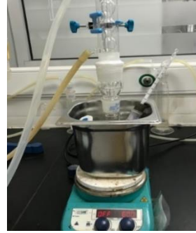
Şekil 1. Optimal modifikasyonun bulunması için farklı AMMO miktarları ile zeolitin modifikasyonu ve zeolitlerin silan modifikasyonu için kullanılan sistem
