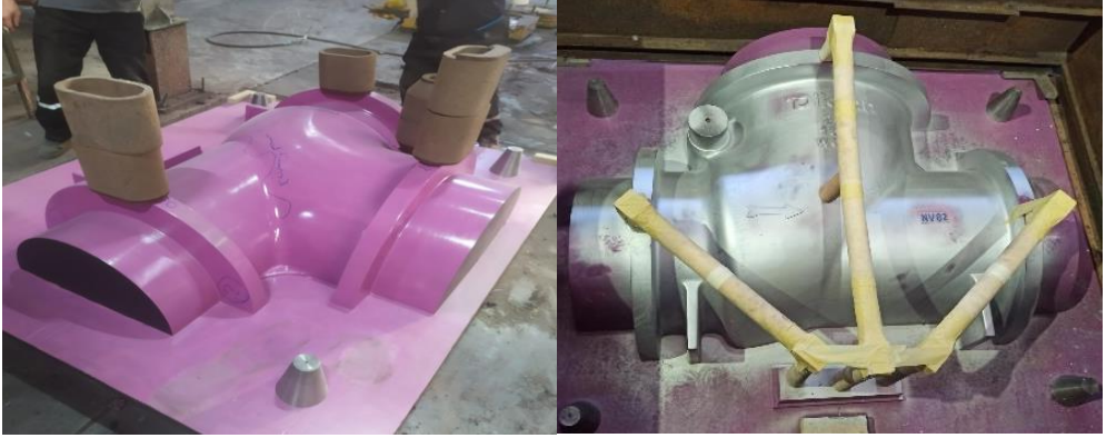
Şekil 4. Çalpara çekvalf gövde model fotoğrafları.
